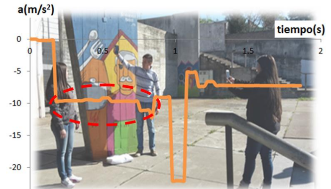
59 FIGURA 3. Aceleración en función del tiempo en trazo continuo 60 de color anaranjado. A modo ilustrativo en la imagen de fondo del 61 gráfico se aprecia cuando se suelta el smartphone y se mide con 62 otro smartphone la altura usando la aplicación Smart Measure. El 63 óvalo en líneas de punto indica la caída libre del Smartphone. 64
