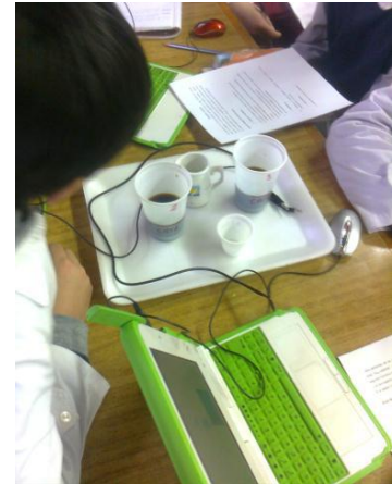
Figura 1. El dispositivo experimental es muy sencillo y de bajo costo, Las XO registran la temperatura como función del tiempo.
