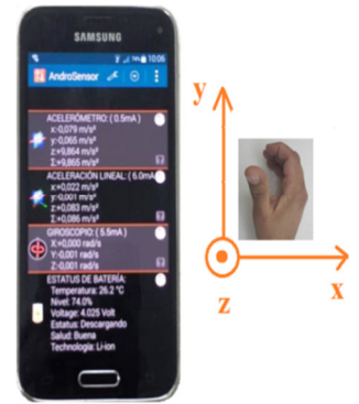
Figura 1. Ilustración del Smartphone. A la izquierda se muestra como se designan las direcciones y sentidos de los ejes del smartphone.
