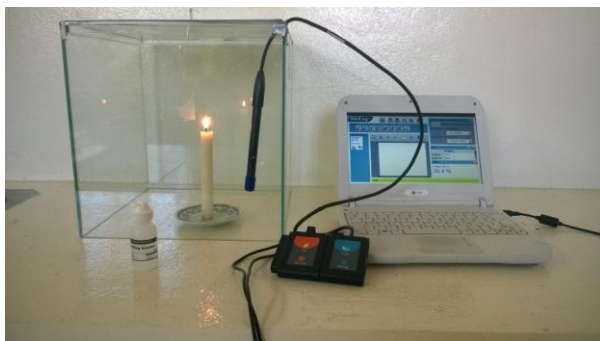
Figura 1. A la izquierda se muestra el diseño experimental usado y a la derecha los resultados experimentales obtenidos. El nivel de oxígeno en aire al apagarse la vela es de aproximadamente 16%.
