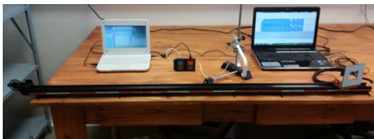
Figura 6. Modificación posible del sistema inicial, usar riel metálico, celular, PC y celular.
